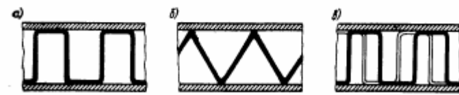
Рис. 2.7. Схемы пластинчатых поверхностей: а, б — с гладкими ребрами; в — с прерывистыми ребрами
